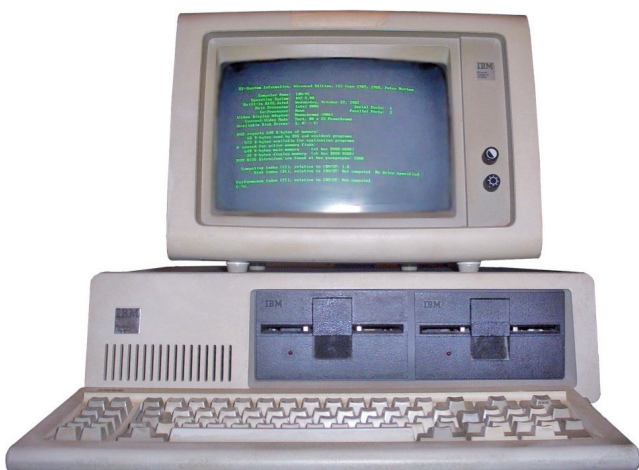
Abb. 4: Der IBM Personal Computer, Modell 5150, war 1981 das Urmotiv der heutigen IBM-kompatiblen PCs.
