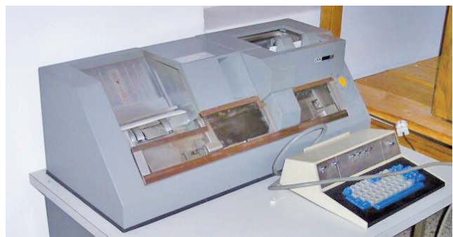
Abb. 1: Lochkartenstanzer 029 von IBM mit Bedienstation
